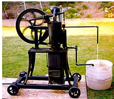
เครื่องสูบน้ำทำงานด้วยเครื่องยนต์สเตอร์ลิง
